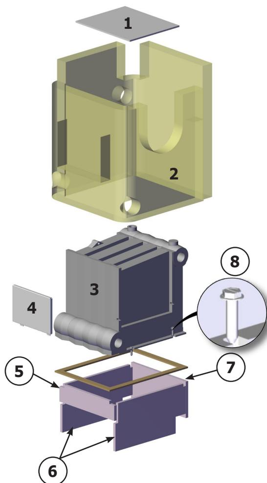
Lors de l'évaluation du remplacement du bloc htex, veuillez examiner les pièces isolantes si nécessaire.
