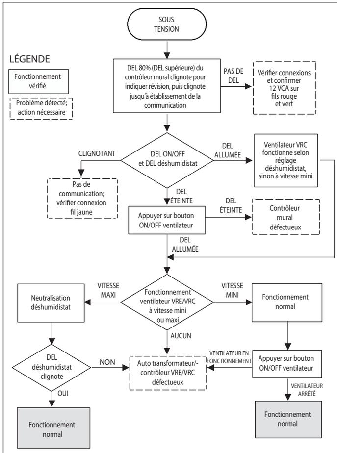
Figure 52. Schéma opérationnel du VRE/VRC
