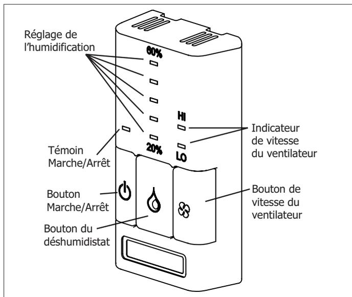
Figure 12. Contrôleur à bouton-poussoir H/C VRE/VRC (Y8249)
