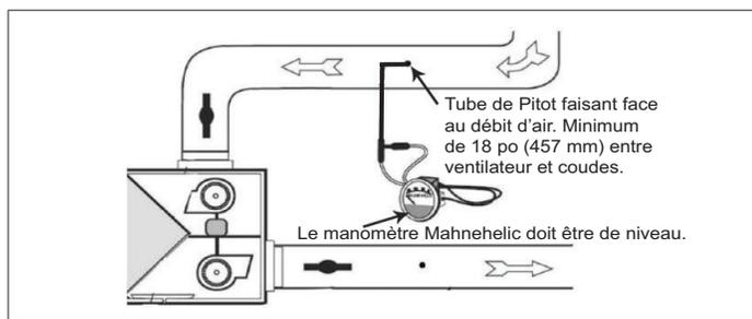
Figure 46. Insérer le tube de Pitot
