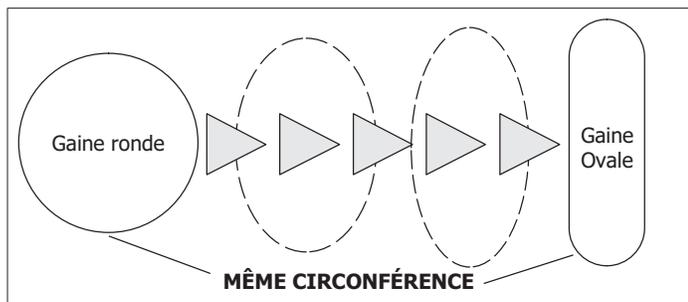
Figure 6. Formage des gaines pour les orifices ovales
