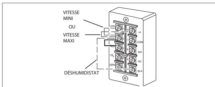
Figure 41. Addition de contrôleurs à contacts secs
