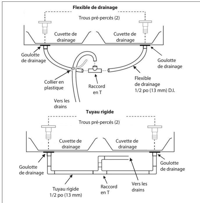
Figure 28. Trous de drainage et siphon (VRE/VRC)
