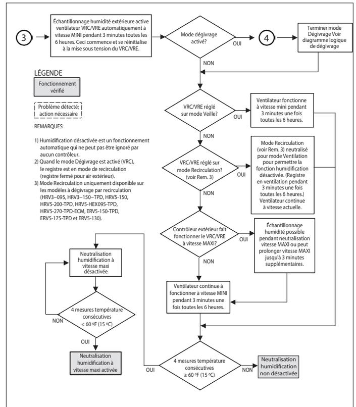
Figure 55. Déshumidistat désactivé
