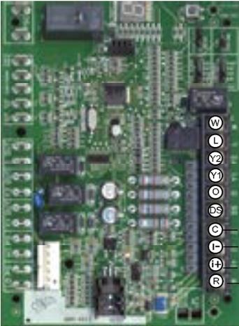
**iComfort por Lennox™ CALEFACTOR (IFC) O UNIDAD DE CLIMATIZACIÓN DE AIRE (AHC)**
