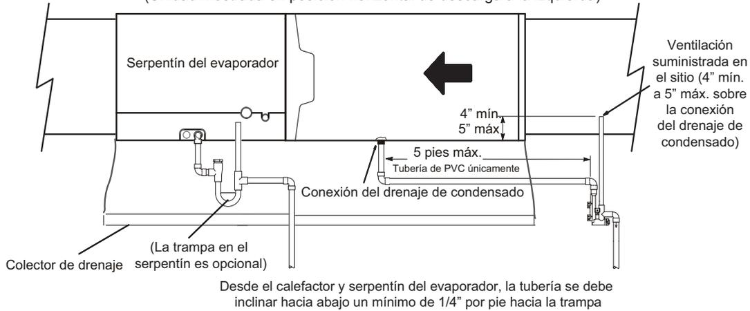
Desde el calefactor y serpentín del evaporador, la tubería se debe inclinar hacia abajo un mínimo de 1/4" por pie hacia la trampa
