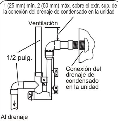
Ensamble de trampa de condensado con tubería de 3/4 pulg.
