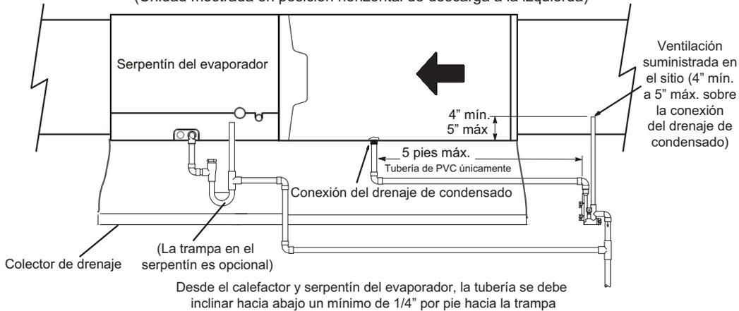
Desde el calefactor y serpentín del evaporador, la tubería se debe inclinar hacia abajo un mínimo de 1/4" por pie hacia la trampa
