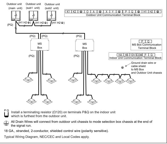
Figure 17. VRF System Communication Wiring Diagram
