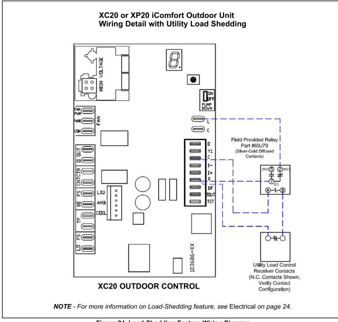
Figure 24. Load-Shedding Feature Wiring Diagram
